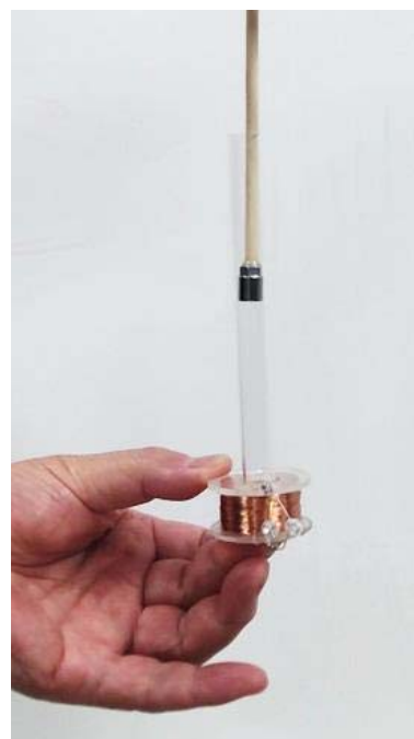
図 2. 実験 1 のコイルの持ち方
